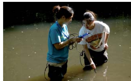
Këta nxënës shfrytëzojnë matës oksigjeni që të masin koncentrimin e oksigjenit të tretur në ujë
